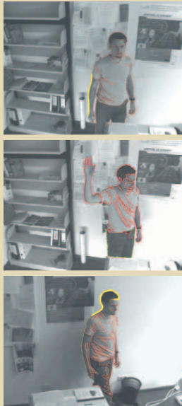
Das Mehrkamerasystem im Labor: Die Umriss der Personen werden erfasst und Bewegungen erkannt.
